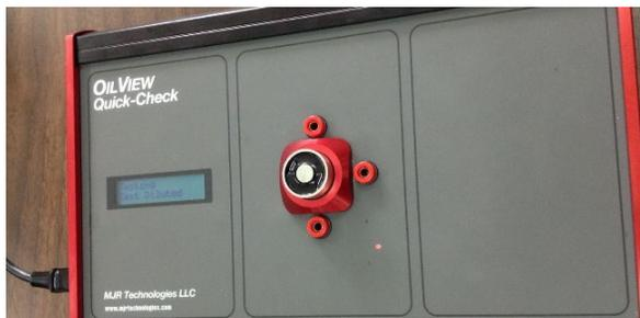
Ilustración 170.- Calibración del viscosímetro.
