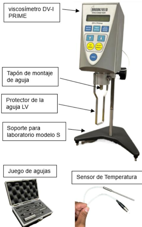
Ilustración 91.- Componentes del Viscosímetro DV-I PRIME
