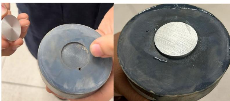
Ilustración 138.- Se coloca la probeta en el portadiscos.
