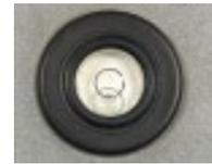
Ilustración 163 Nivelación de la burbuja de aire del viscosímetro
