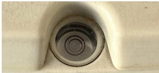
Ilustración 60.- Burbuja de aire nivelada.
