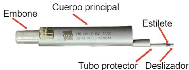
Ilustración 37.- Componentes del sensor.
