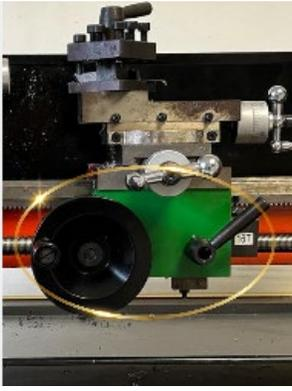
Ilustración 8.- Carro Longitudinal / Principal.
