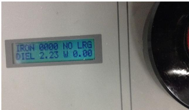
Ilustración 171.- Obtención del Dieléctrico.
