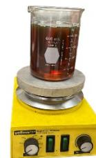
Ilustración 162 calentamiento del aceite lubricante a 40 OC
