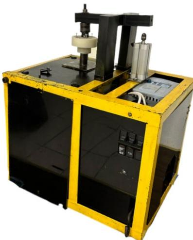
Ilustración 75.- Tribómetro pin sobre disco.
