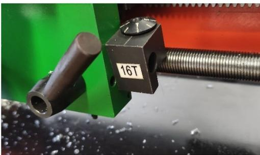
**Ilustración 22.- Palanca de bloqueo del carro.**
