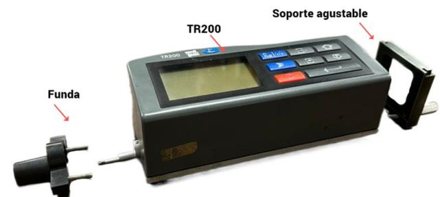
Ilustración 42.- Conexión de sensor ajustable y Funda de sensor.
