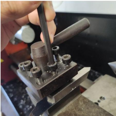
**Ilustración 15.- Sujetando el buril.**
