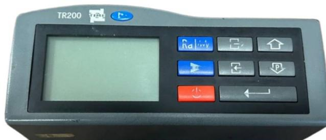
Ilustración 31.- Rugosímetro portátil modelo TM-TR200.
