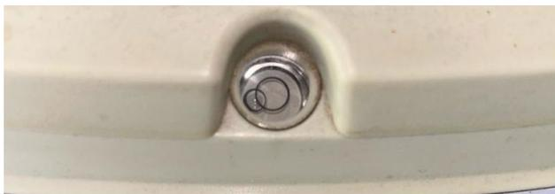
Ilustración 59 Burbuja de aire no nivelada
