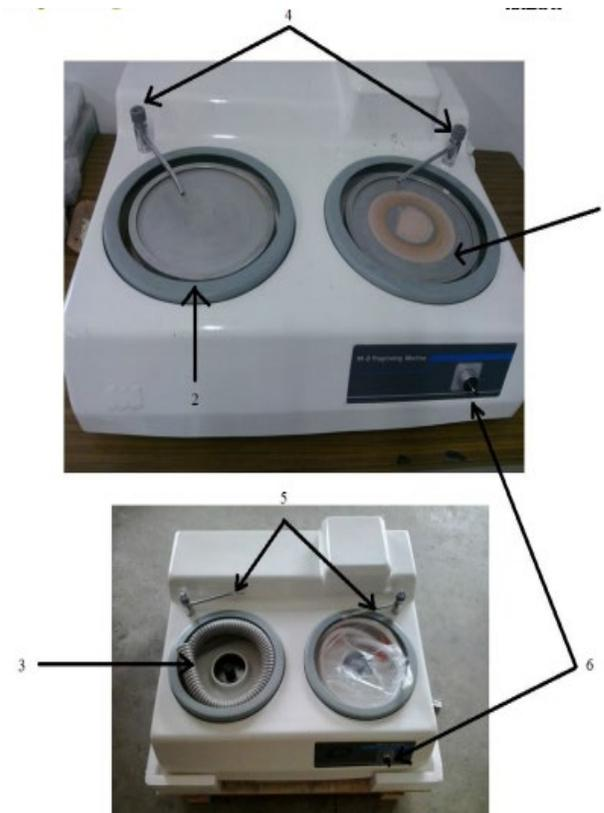
Ilustración 28.- Partes de la pulidora metalográfica.
