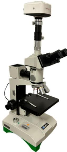
**Ilustración 63.- Microscopio metalográfico.**
