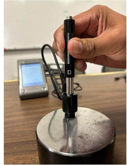
Ilustración 178.- Forma de calibrar el durómetro.
