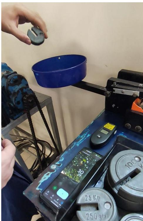
Ilustración 109.- se inserta la siguiente carga después de 30 s.
