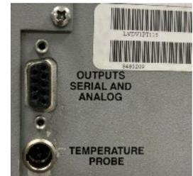
Ilustración 166 Entrada sensor de temperatura
