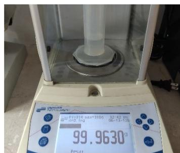
Ilustración 151.- Probeta con 30 ml de agua.
