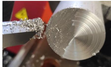
**Ilustración 24.- Imperfección en la cara de la pieza.**
