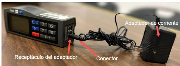
**Ilustración 44.- Conexión del Adaptador de Poder.**
