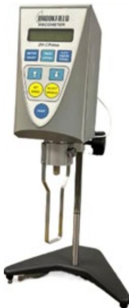
Ilustración 89.- Viscosímetro.
