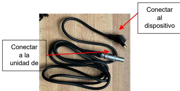
Ilustración 55.- Cable de señal.
