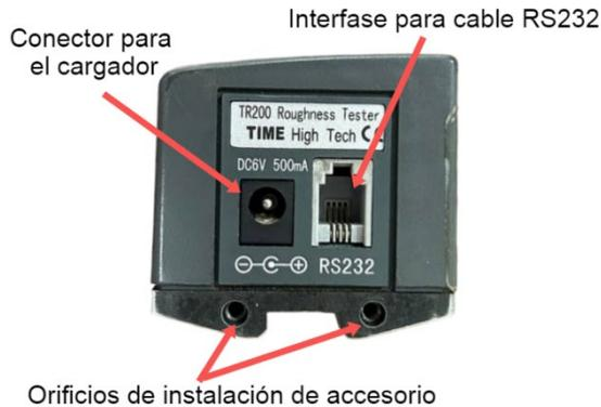
Ilustración 40.- Vista Lateral del instrumento.
