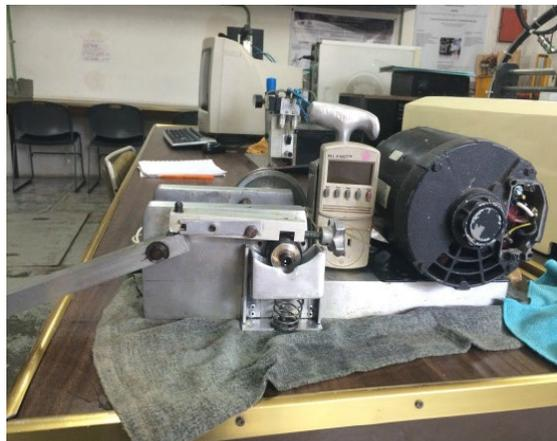
**Ilustración 168. Máquina Timken, ensamblada en el Laboratorio de Tribología**
