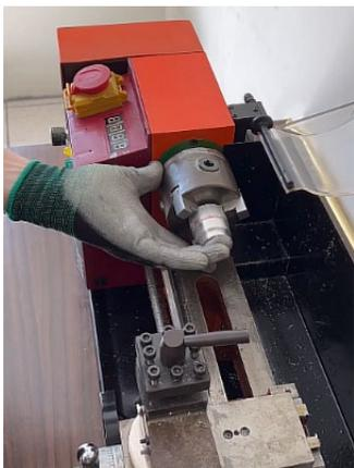
Ilustración 136.- Manufactura de probetas de aluminio.
