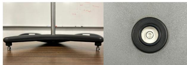
Ilustración 95.- Nivelación Viscosímetro.
