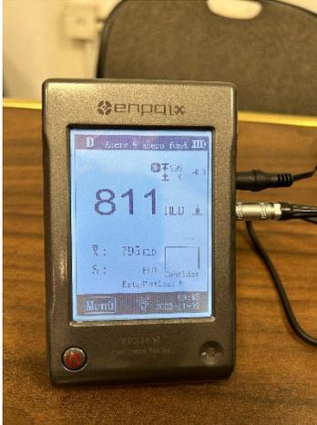
Ilustración 174.- Pantalla principal del durometro.
