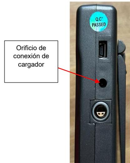
Ilustración 56.- Puertos de conexión.
