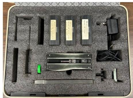
**Ilustración 141.- Estuche del rugosímetro TM-TR200.**
