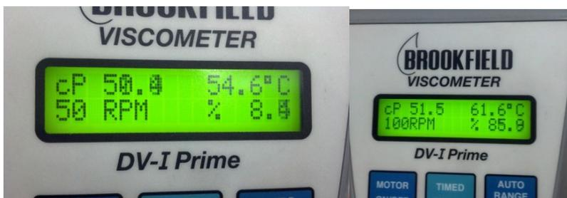
Ilustración 167.- A) Lectura incorrecta por insuficiencia de porcentaje. B) Lectura correcta.
