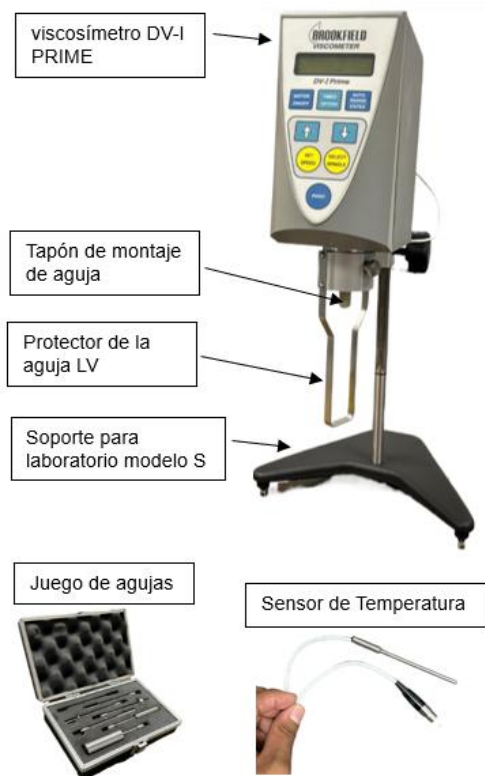
Ilustración 83.- Componentes del Viscosímetro DV-I PRIME
