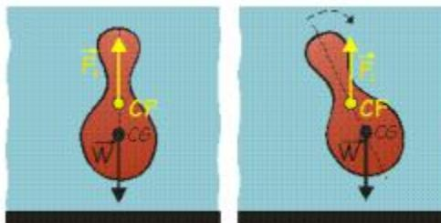
Equilibrio inestable: cuando el par de fuerzas tiende a aumentar el desplazamiento angular producido. Esto ocurre cuando el cuerpo tiene mayor densidad en la parte superior del cuerpo, de manera que el centro de gravedad se encuentra por encima del centro de flotación.
