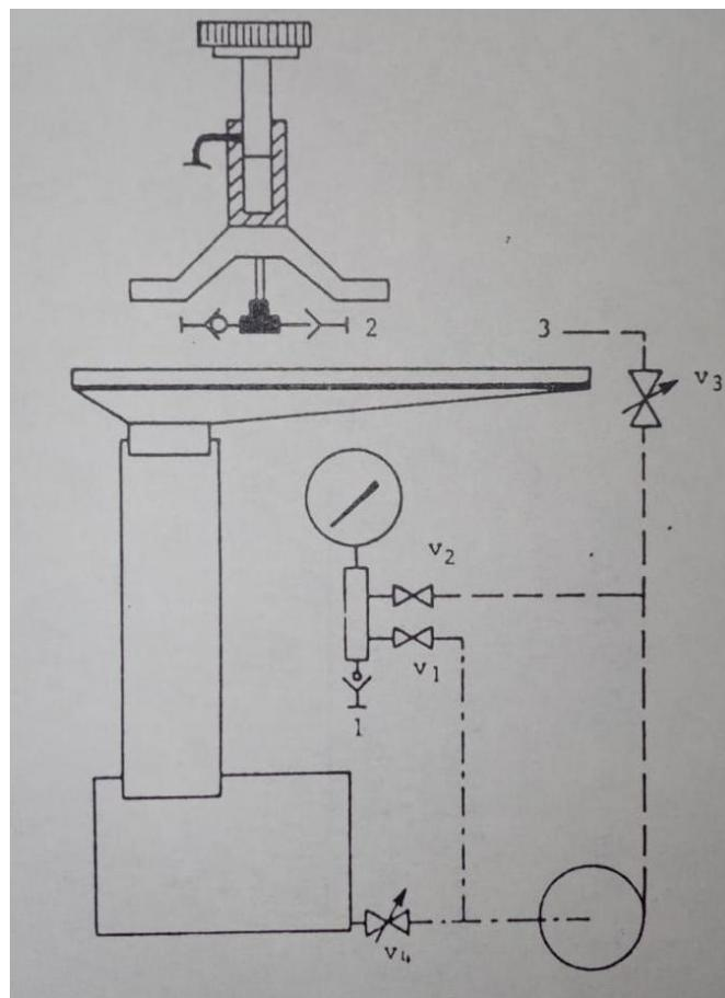
Es apropiado realizar por lo menos dos ciclos completos de descarga y carga. La comparación entre los resultados obtenidos durante el ciclo de carga y el de descarga permiten que se verifique la histéresis del instrumento.
