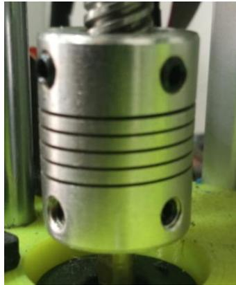
*Ilustración 5.- Acople flexible para motores nema 17
