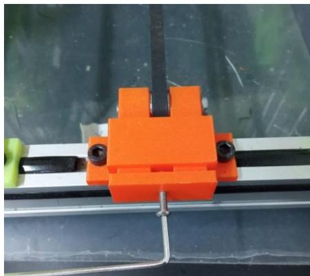
Ilustración 12.- Ajuste del tensor de correa en el eje Y
