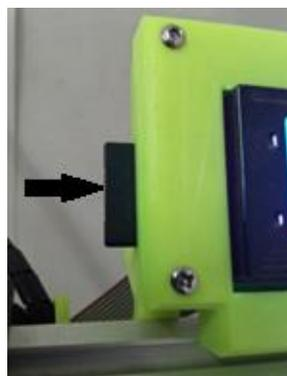
Ilustración 21.- Tarjeta microSD en el puerto de la impresora
