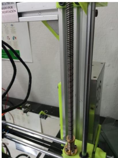
Ilustración 3.- Husillo del motor del eje Z
