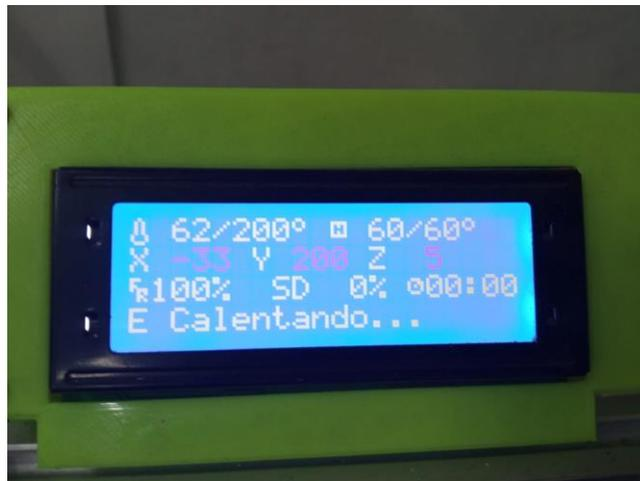
*Ilustración 22.- Preparación del nozzle y placa de impresión
