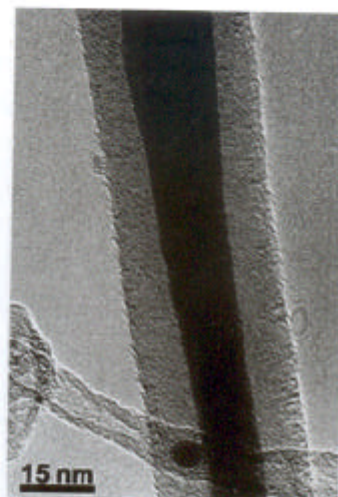
Figura 3. Fotografía de un nanotubo de carbono lleno de hierro.
