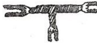
Toma para cables
