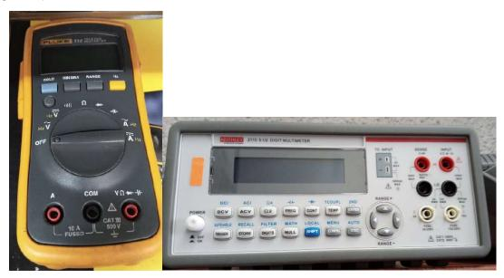
Estos aparatos pueden medir las tres variables eléctricas más importantes: Resistencia, corriente y voltaje. Para medir la resistencia eléctrica de un componente es necesario conectar las puntas del multímetro a las terminales indicadas. Para medir la resistencia, las puntas deben conectarse en paralelo con el elemento a medir.
