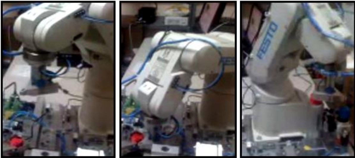
a) Espera de pieza y habilitación de la interrupción, b) Sensado de color de la pieza y deshabilitación de interrupción y c) Colocación de pieza en contenedor, dependiendo el color.
