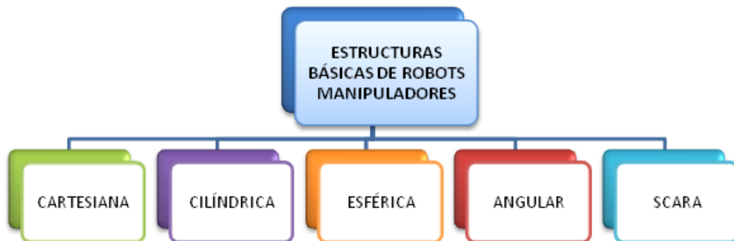
Figura 1.3: Tipos de configuraciones de robots industriales manipuladores.
