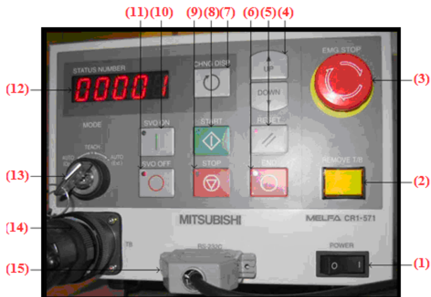
Figura 2.2: Panel frontal de operación del controlador CR1-571.
