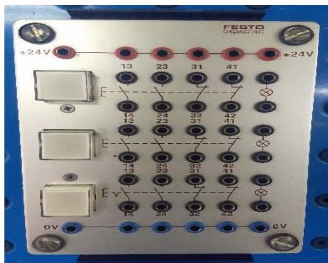
Figura 6. Botonera de entrada de señales eléctricas.
