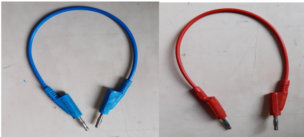
Figura 33. Cables de seguridad.
