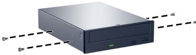
Figura 2-24 Instalación de tornillos de guía en la unidad óptica
