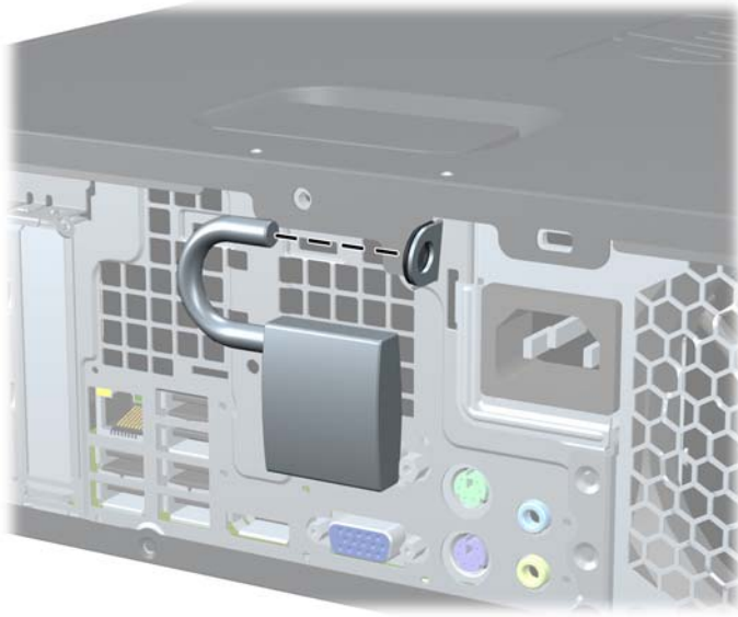
Figura C-2 Instalación de un candado
