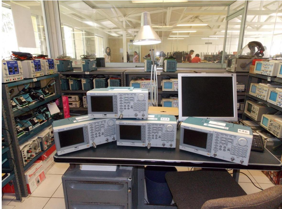
Generadores de funciones DDS Arbitrario (cuatro), adquiridos con apoyo PIFI 2012. Equipo ubicado en el laboratorio de Electrónica de la facultad.
