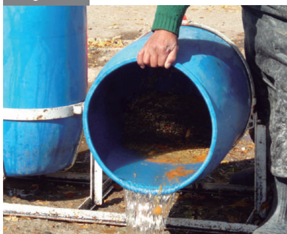
Lavado por agitación y decantación. Se muestra el momento en que se extrae el agua con las impurezas mediante la inclinación del recipiente. Foto: Julio Gaviola.
