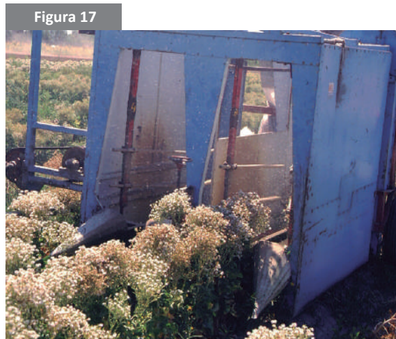
Equipo de cosecha de semilla de lechuga por sacudimiento. Foto: Julio Gaviola.
