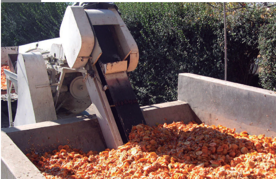
Lagar cargado con la masa de pulpa y semillas extraídas manualmente. Se muestra también el elevador y la máquina extractora. Foto: Julio Gaviola.
