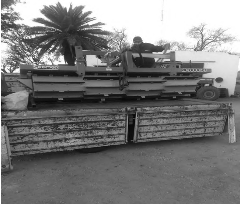
Fig. 13. Rolo triturador utilizado en el campo escuela de la Facultad de Ciencias Agropecuarias de la Universidad Nacional de Córdoba (Fotografiado por Ing. Agr. Juan Sánchez). El mismo requiere algunas modificaciones para aplastar tallos sin triturar.
