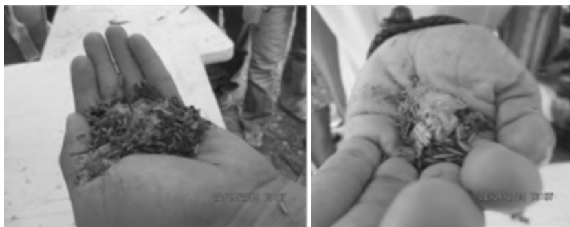
Fig. 3. Restos de mantillo o broza con suelo con burbujeo ante el agua oxigenada.
