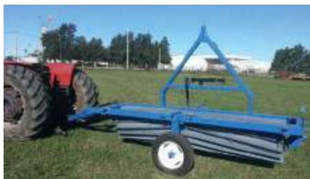
Rolo mellador de cuchillas helicoidales en posición de transporte. Carcaraña, Santa Fe, 2019.
