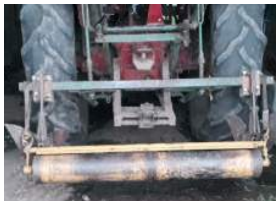
Escardillo de 3 puntos adaptado para elaboración de platabanda con rolo asentador de lomo. Villa Gdor Galvez, Santa Fe.
