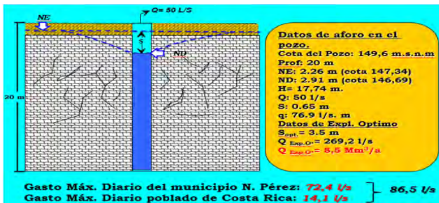
Figura 3. Análisis de la fuente de agua existente y propuesta para el abasto a N. Pérez y Costa Rica. Pozo 18. (Santa Rita).
