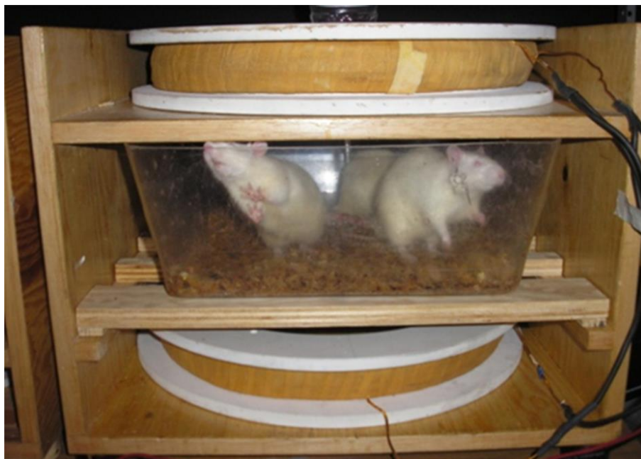
Figura 1. Fotografía del dispositivo de estimulación magnética. Par de bobinas en configuración Helzthoth colocadas por arriba y debajo de la caja de acrílico donde vivían los animales.
