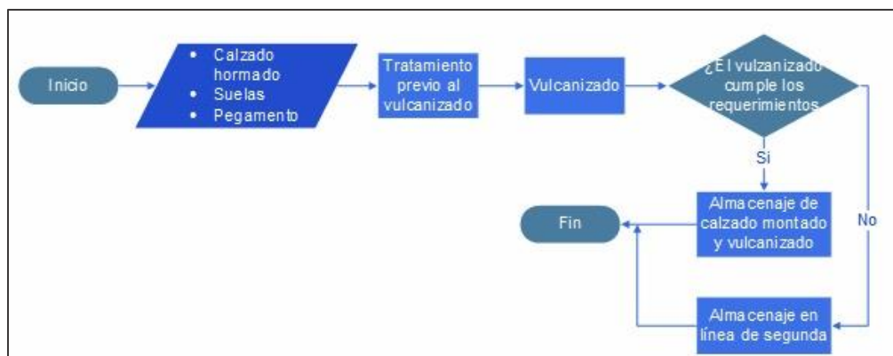
Figura 14. Proceso de solado de la empresa CalzaT-Eco Referencia: elaboración propia con datos de CalzaT-Eco, 2020
