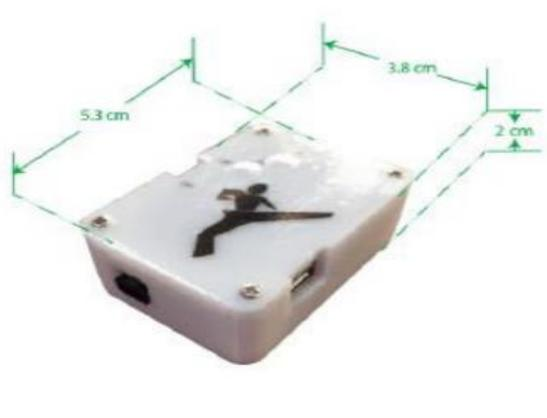
Imagen 3.3 Caja de control TKP V3. Fuente: elaboración propia basada en la información de la empresa, 2019.
