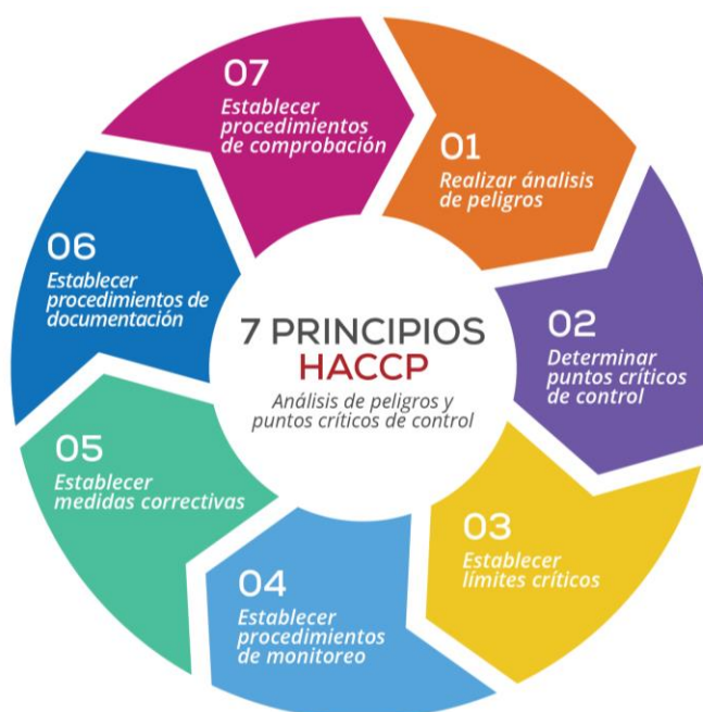
Imagen 4.12 Implementación del Sistema de Análisis de Peligros y Puntos Críticos de Control. (Global STD Certification, 2017).
