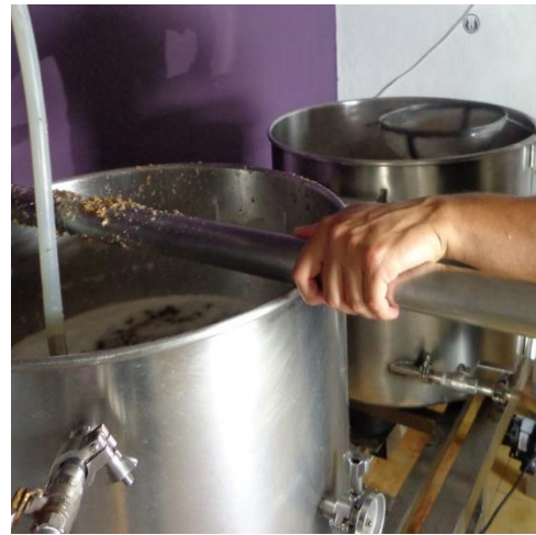
Imagen 3.6 Sparging. (Elaboración propia).
