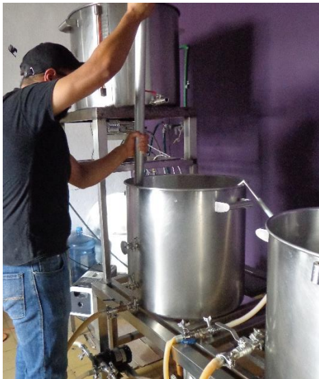
Imagen 3.5 Recirculación. (Elaboración propia).
