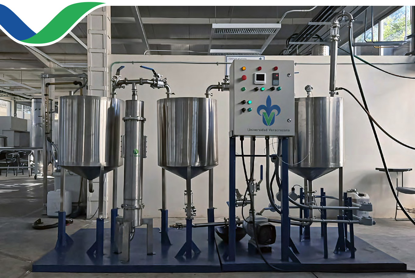
Planta piloto para la producción de biodiesel a partir de grasas animales, desarrollada por investigadores de la UV y la Universidad Autónoma del Estado de Hidalgo, en colaboración con estudiantes de Ingeniería Química. El proyecto, respaldado por la patente número 382447, promueve la sostenibilidad mediante la valorización de residuos grasos. Región Orizaba-Córdoba. Foto: Facultad de Ciencias Químicas.
