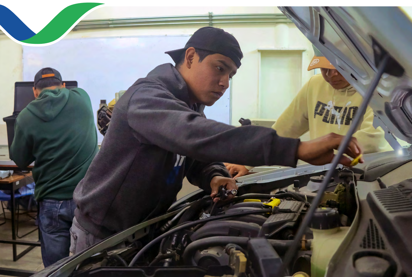
Alumnos de la Facultad de Ingeniería Mecánica Eléctrica llevando a cabo prácticas de mantenimiento y reparación en el sistema mecánico de un vehículo. Región Orizaba-Córdoba. Foto: Dirección de Planeación Institucional.
