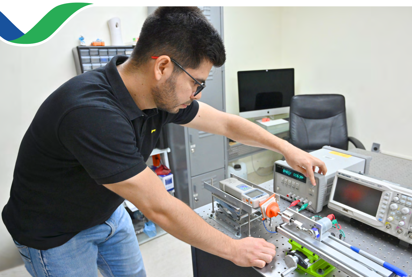
Alumno de Doctorado en Materiales y Nanociencia, caracterizando el funcionamiento eléctrico de un nanogenerador triboeléctrico basado en hoja de maíz y mango. Centro de Investigación en Micro y Nanotecnología (Microna). Región Veracruz. Foto: Dirección General de Tecnología de Información.
