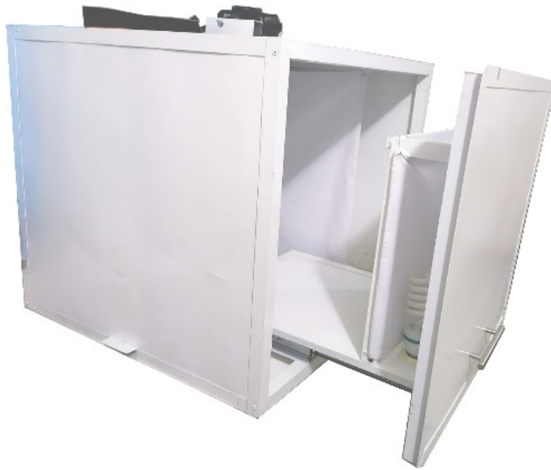
FIGURA E.1. Caja fotográfica con difusor de luz.
