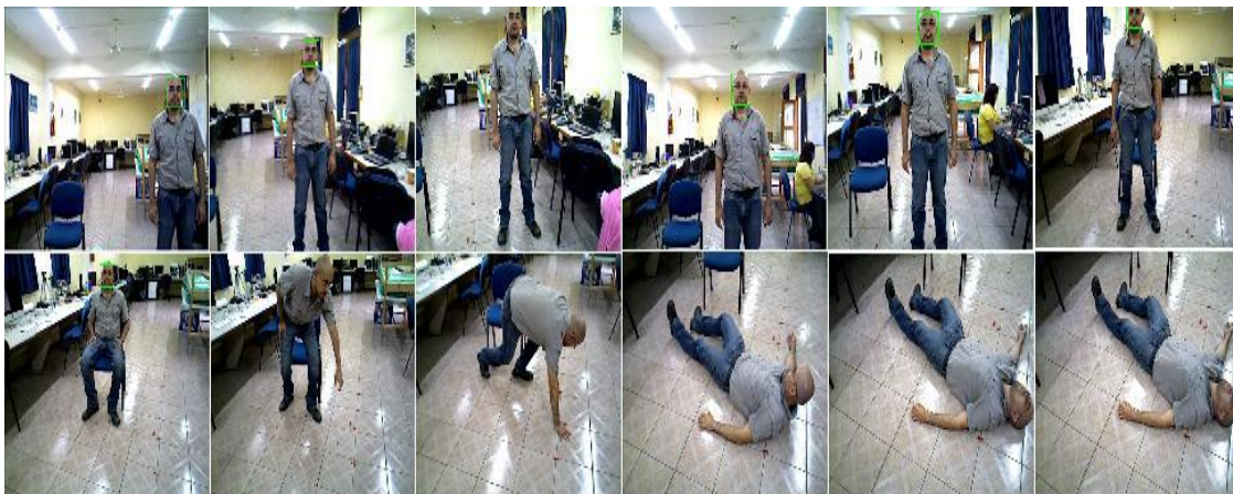
FIGURA 29. En la imagen de la esquina superior izquierda, la capa tres detecta el rostro de una persona, en la imagen se observa como la persona está fuera del foco de la imagen. Los módulos de la capa dos se activan y se observa como la persona es centrada en el plano de la imagen y posteriormente se detecta la caída.
