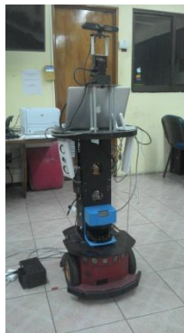
FIGURA 23. El robot se encuentra en el centro de investigaciones de inteligencia artificial. En la parte superior del robot se observa el Kinect montado sobre una PTU.
