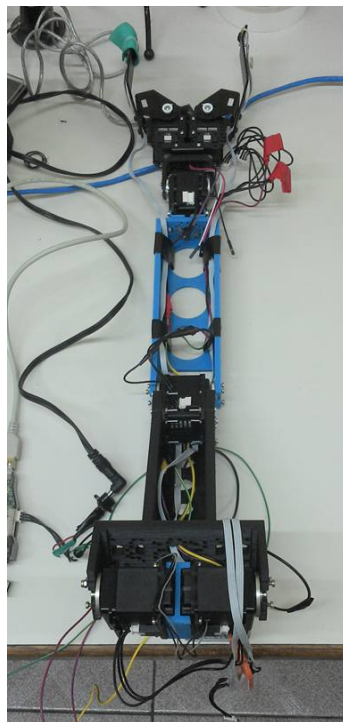
FIGURA B.11: Prototipo de brazo finalmente armado
