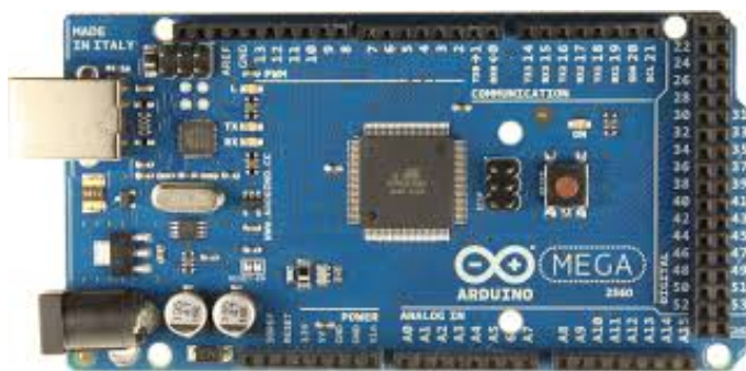
FIGURA 4.7: Tarjeta Arduino Mega.
