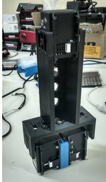
FIGURA B.10: Ensamble de los dos motores dynamixel MX-106T
