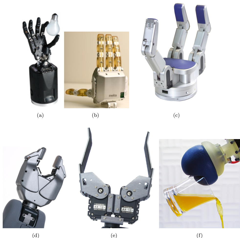
FIGURA 2.1: Diferentes tipos de pinzas robóticas a) Mano shadow (5 dedos)[20], b) Meka Robotics H2 (4 dedos) [29], c) Mano barret (3 dedos) [5], d) Pinza paralela (2 dedos)[79], e) Pinza angular de dos dedos, f) Pinza Universal [11].
