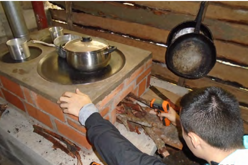
Medición de temperatura y pesaje de ceniza
