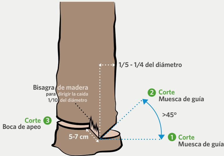
**Figura 5.** El derribo direccional, pasos 2, 3 y 4.
