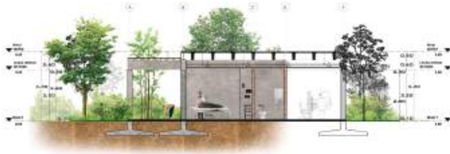
Figura 5. Corte transversal del módulo de consultorios
