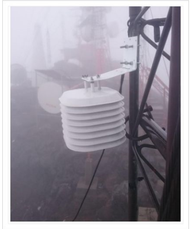
Equipo Onset HOBO Termohigrómetro en su "radiation shield" instalada por la Universidad Veracruzana en el Cofre de Perote. Foto y texto de Marco Aurelio Morales Martínez, licenciado en Biología, Maestro en Estudios Regionales colaborador en el Centro de Ciencias de la Tierra.
