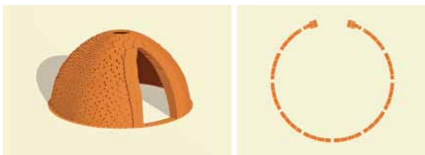
Figura. 13. Acomodo de los ladrillos para construir la pared
