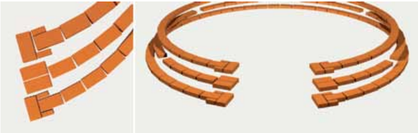
Figura 8. Forma correcta de colocar y amarrar los ladrillos en el borde de la puerta
