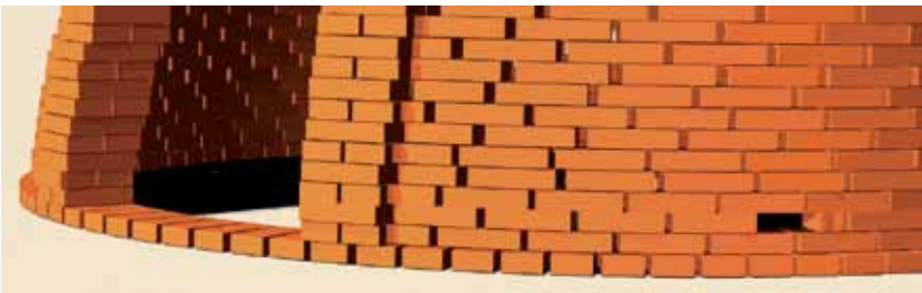
Figura 9. Acomodo de los ladrillos para construir la pared
