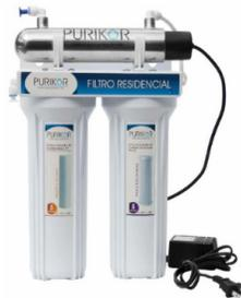
Filtro purificador de dos etapas con cartuchos de antisedimentos de polipropileno, carbón block activado de cascara de coco y luz ultravioleta, ideal para uso residencial.
