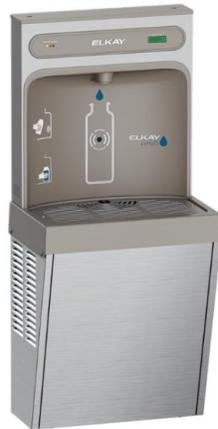
Estación de llenado de Botellas provisto de enfriador de agua con capacidad de 30 litros por hora, con green ticker que indica la cantidad de botellas de plástico ahorradas al medio ambiente. Llenado con sensor óptico para llenado de botellas con apagado automático. Mueble en acero inoxidable con salida a drenaje. (presión mínima de operación 20 psi, voltaje 115v, dimensiones 646 mm. altura x 456mm de largo x 208mm de ancho. **NO INCLUYE FILTRO DE PURIFICACIÓN DE AGUA.**
