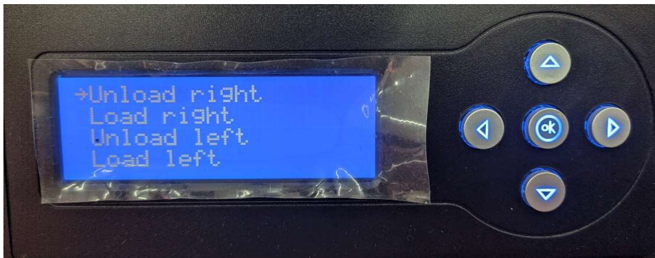
Ilustración 6 Pantalla de carga de filamento de la impresora
