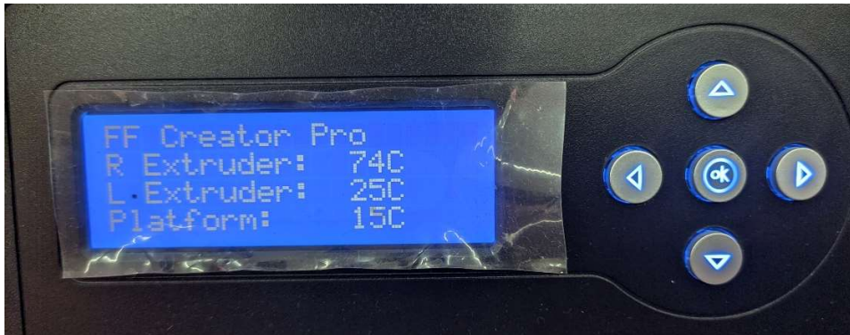
Ilustración 5 Pantalla de modo monitor de la impresora
