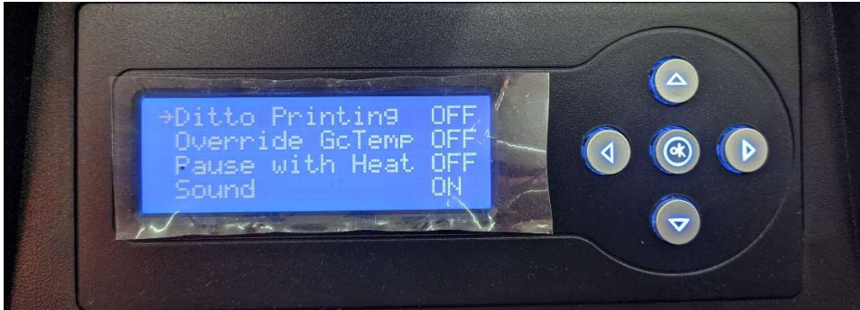
Ilustración 8 Pantalla del menú de ajustes generales de la impresora
