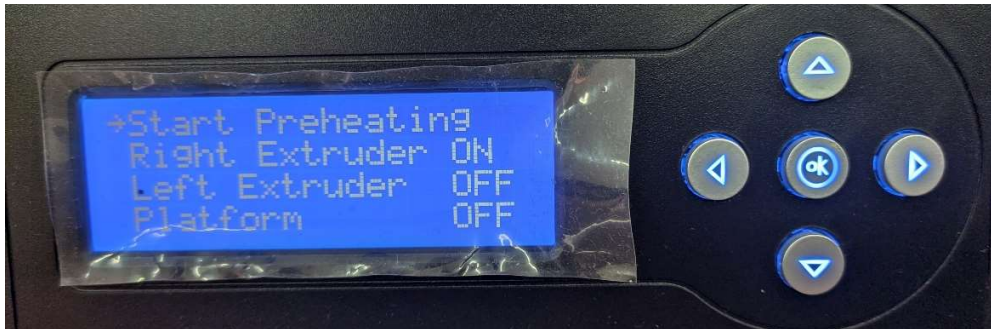
Ilustración 3 Menú de precalentado de la impresora 3D
