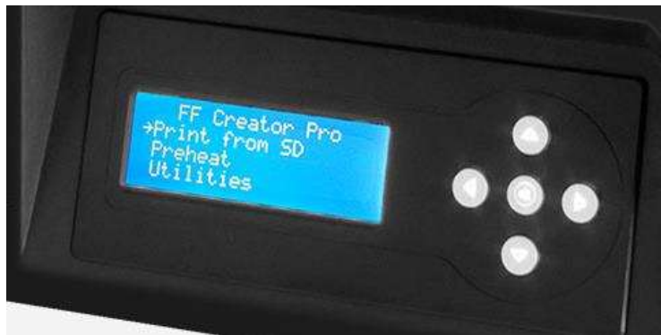
Ilustración 2 Panel de control de la impresora, se muestran los menús y botones.
