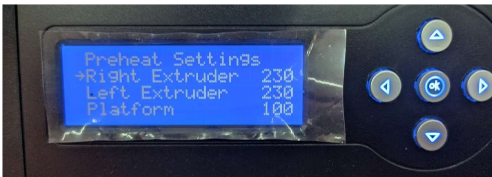
Ilustración 7 Pantalla de opciones de precalentado de la impresora
