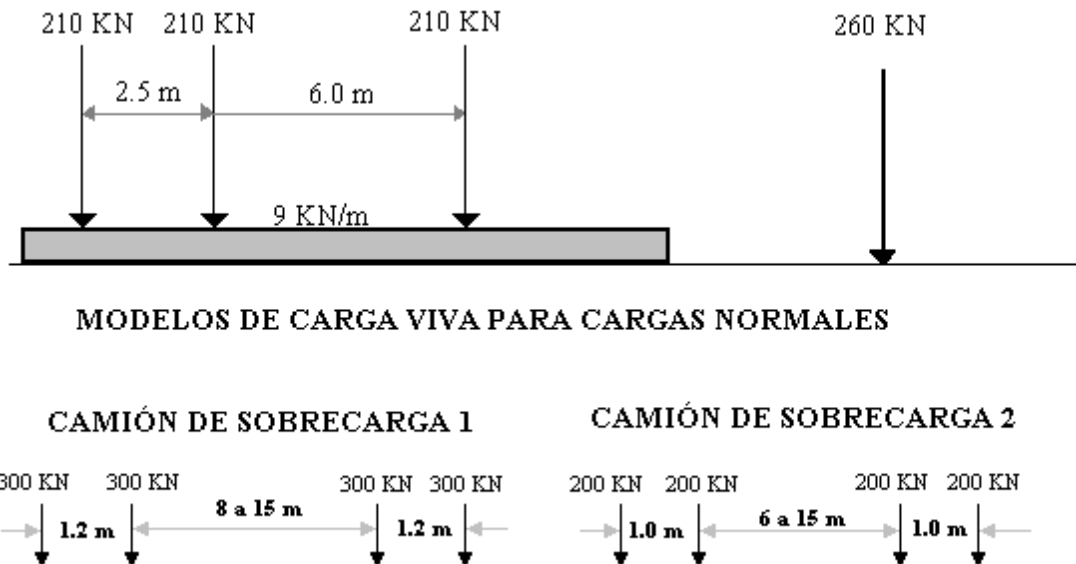
FIGURA 2.3 Modelo de Carga Viva Finlandés
