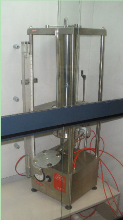
CONTACTO RESIDUAL con Torre de Potter
