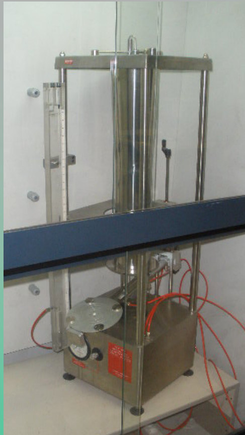
CONTACTO RESIDUAL con Torre de Potter
