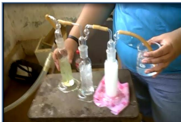
Fig. 2. Proceso químico para determinar la concentración de H 2 S.
