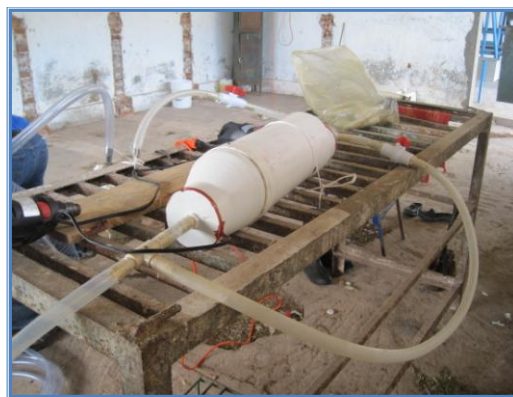
Fig. 5. Diseño del soplador, encapsulado para que no se contaminara el biogás con el aire.
