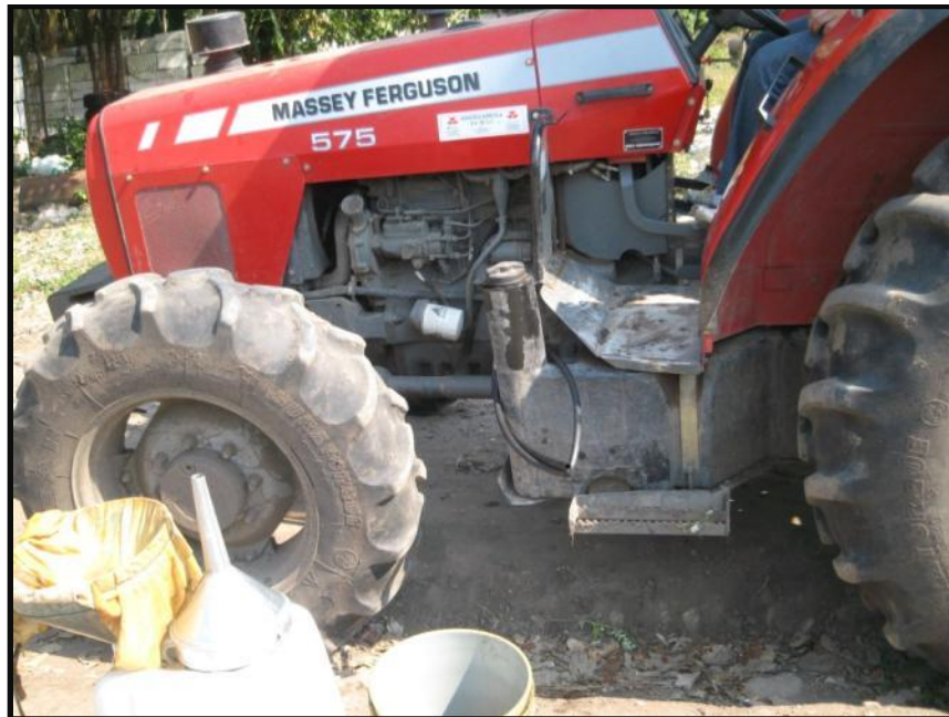
Fig. 2. Llenado del tanque del tractor con mezclas de Biodiesel-Diesel
