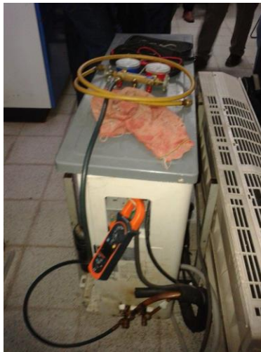
Medición de Amperaje y Presión
