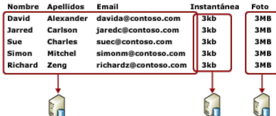
Figura 1.2: Ejemplo de particionamiento vertical.
