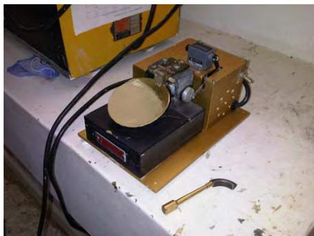
Figura 9. Muestra para ensaye de límite líquido.
