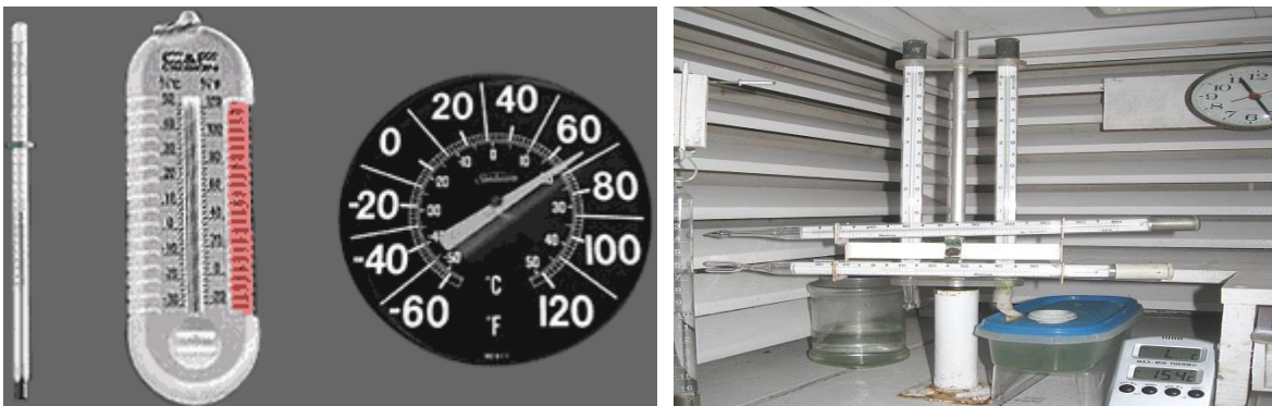
Figura 1. Tres tipos de termómetros convencionales, Izquierda. / Derecha: termómetros en estación meteorológica protegidos de la radiación y el agua.
