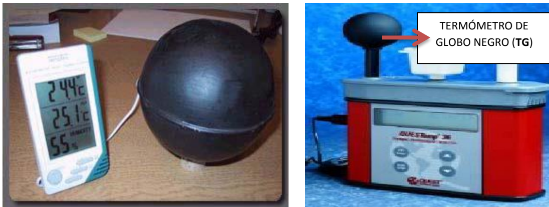
Figura 3. Equipo para medir TBN izquierda y QUEST Temp o 36 utilizado en este estudio, derecha. [fuente http://www.grupomeyer.com.mx/quest_36.php ], Consultada en agosto 2014]
