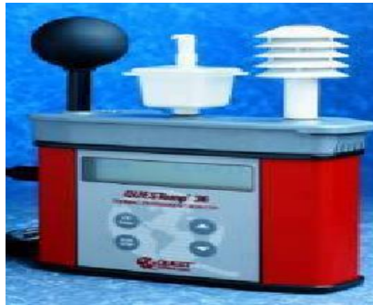
Figura 6. Monitor de estrés térmico Quest Temp o 36 (caja roja) el cual tiene un largo aproximado de 17 cm. [fuente http://www.grupomeyer.com.mx/quest_36.php .], Consultada en agosto 2014]
